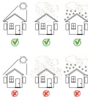
Figura 6 - Local de instalação do Inversor
