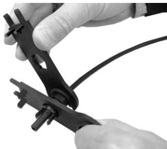
Figura 24 - Uso das Chaves para aperto correto do prensa cabo
